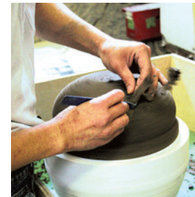
職人の熟練の技が光る削り出し。石膏型から取り出された粗土の土鍋を丁寧にカンナで削り、鍋底の火に当たる表面積を増やします。
