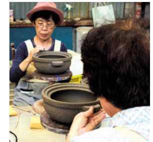
水でのばした土を糊にして「耳」と呼ばれる土鍋の持ち手を付けていきます。
