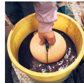
乾燥・素焼きを経た土鍋に、手作業で釉（うわぐすり）を施します。
