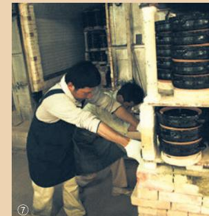
①②たくさんのお試作を重ねて新商品が生まれます（写真はその一部）。③伊賀の土は400万年前の古琵琶湖層と呼ばれる土の層から採られます。この土を石膏型で成形します。④職人の熟練の技が光る削り出し。石膏型から取り出された粗土の土鍋を丁寧にカッタで削り、鍋底の火に当たる表面積を増やします。⑤水でのばした土を糊にして「耳」と呼ばれる土鍋の持ち手を付けていきます。⑥乾燥・素焼きを経た土鍋に、手作業で釉（うわぐすり）を施します。⑦本焼きされた土鍋は1個1個チェックされ、みなさまのお手元に届けられます。
