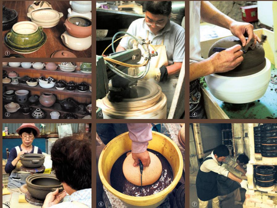
①②たくさんの試作を重ねて新商品が生まれます(写真はその一部)。③伊賀の土は400万年前の古琵琶湖層と呼ばれる土の層から採られます。この土を石膏型で成形します。④職人の熟練の技が光る削り出し。石膏型から取り出された粗土の土鍋を丁寧にカンナで削り、鍋底の火に当たる表面積を増やします。⑤水でのばした土を糊にして「耳」と呼ばれる土鍋の持ち手を付けていきます。⑥乾燥・素焼きを経た土鍋に、手作業で釉(うわぐすり)を施します。⑦本焼きされた土鍋は1個1個チェックされ、みなさまのお手元に届けられます。
